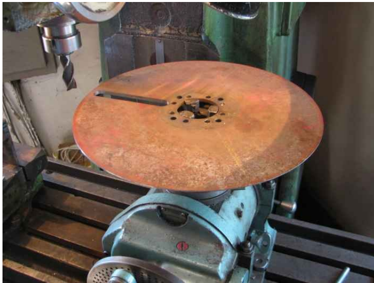
Мал. 9 Фрезерівка паза шириною 21 мм
