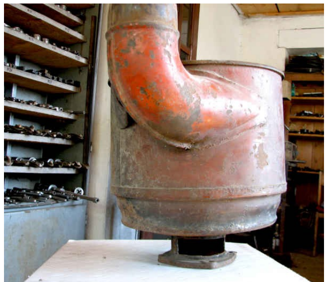
З вирізкою для проходження клинового ремня
