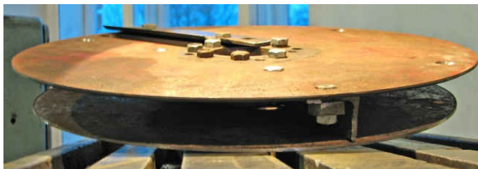
Мал. 11 Ріжучий і викидаючий диски закріплені на шліцьовій втулці
