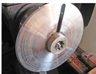
Мал.13 Оправка та балансування дисків
