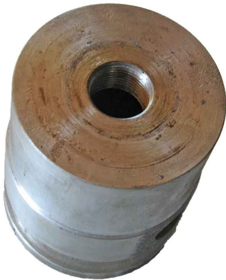
Корпус ріжучого диска Мал.3
