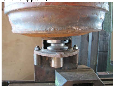
Мал.15 Вирізаний отвір під пасок
