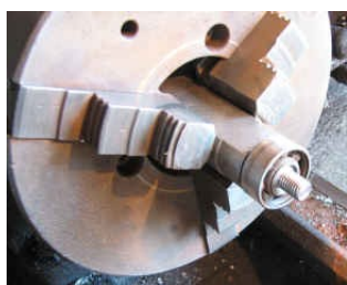
Мал.13 Оправка та балансування дисків
